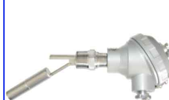
fig 871 (TC4) RVS vlotterschakelaar magnetisch vlottercontact RVS 316 huis en vlotter temp. : max. +150°C 1 omwisselbaar schakelcontact max. 250V - 1,5 A
