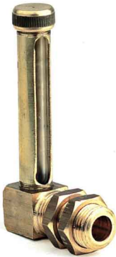
fig 880 messing niveuaanduiding plexiglas aanduidingsbuis max. 10 bar / temp. : max +90°C 1/4" x 100 mm 3/8" x 150 mm 1/2" x 200 mm / 250 mm / 300 mm
