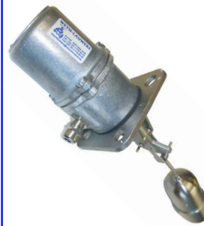
fig 871 (TC4) RVS vlotterschakelaar magnetisch vlottercontact RVS 316 huis en vlotter temp. : max. +150°C 1 omwisselbaar schakelcontact max. 250V - 1,5 A
