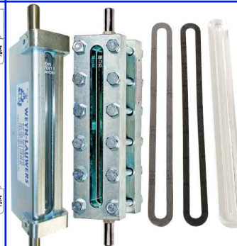
peilglastoestellen voor niveuaanduiding huis staal / borosilicaat glas DIN 7081 max. temp. : +280°C aansluiting buisjes diam. 16 mm / 60 mm lang fig 874 : met reflex glas (reserve gl. fig 876 ) fig 875 : met transparant glas reserve glas fig 877
