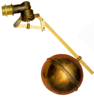
fig 960 messing vlotterafsluiter 1/2" - 2" bsp huis : messing verschuifbare vlotterbol : koper zitting : 1/2" - 5/4" messing zitting : 6/4" - 2" RVS temp. : -5°C/+80°C
