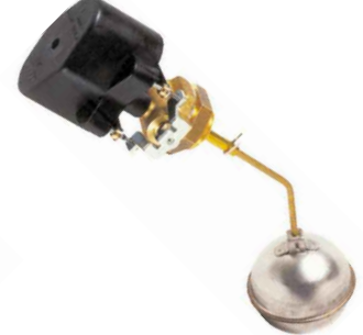
fig 872 (RL2100) vlotterschakelaar 1" bsp huis : messing vlotter diam. 70 mm in RVS temp. : max. +125°C 2 schakelcontacten max. 250V - 1,5 A
