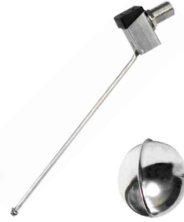
fig 963 RVS vlotterafsluiter 3/8" - 4" bsp huis : RVS 316 / silicone klepdichting opschroefbare vlotterbol : RVS 316 max. druk 10 bar temp. : -5°C/+150°C fig 963NPT 3/8" - 4" npt
