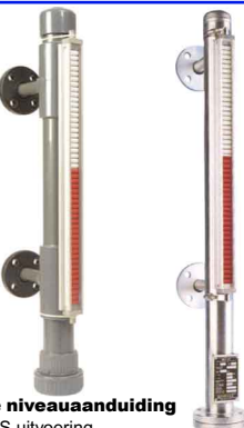
fig 891 RVS niveuaanduiding (zonder glas) RVS316 naaldventiel en bocht 3/8"-1/2"-1" bsp max. druk 16 bar / temp. : -50°C +200°C viton en teflon afdichtingen fig 890 messing niveuaanduiding 1/4" - 3/8" - 1/2" - 3/4" bsp max. 6 bar/80°C fig 878 messing tussenstuk 1/2"x13/16/18/20
