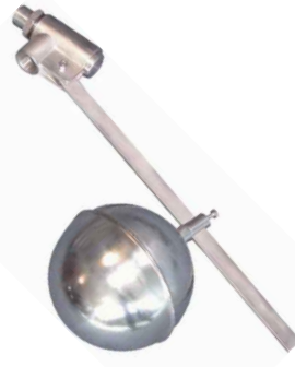
fig 962 RVS vlotterafsluiter 3/4" bsp huis : RVS 304 verschuifbare vlotterbol : RVS 316 viton klepdichting temp. : -5°C/+90°C
