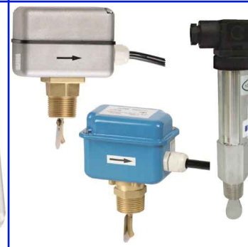
debietschakelaars 1" bsp messing aansluiting 230V 10A max. 10 bar / max. +110°C fig 895 : metalen kast IP54 fig 896 : aluminium kast IP64 fig 897 : RVS 316 1/2"-3/4"-1" bsp IP65 max. 70 bar / max. +150°C
