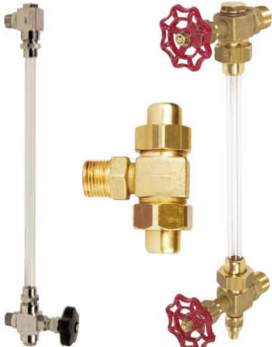
fig 891 RVS niveuaanduiding (zonder glas) RVS316 naaldventiel en bocht 3/8"-1/2"-1" bsp max. druk 16 bar / temp. : -50°C +200°C viton en teflon afdichtingen fig 890 messing niveuaanduiding 1/4" - 3/8" - 1/2" - 3/4" bsp max. 6 bar/80°C fig 878 messing tussenstuk 1/2"x13/16/18/20
