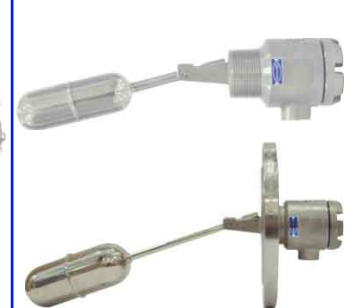
fig 872 (RL2100) vlotterschakelaar 1" bsp huis : messing vlotter diam. 70 mm in RVS temp. : max. +125°C 2 schakelcontacten max. 250V - 1,5 A
